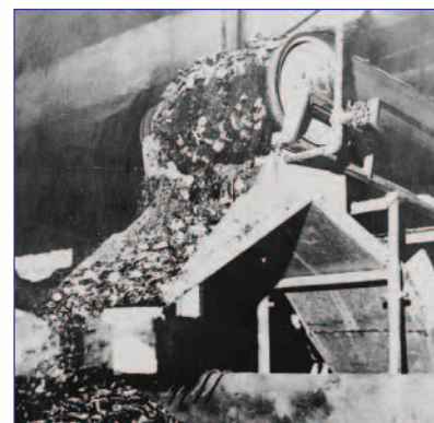
Polia Magnética utilizada em reciclagem de vidro
