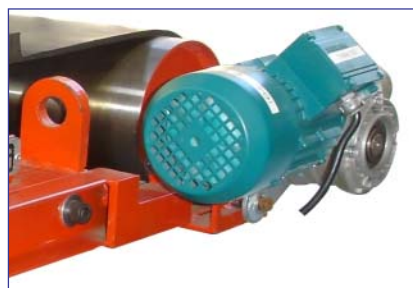
Motorreductor de acoplamento direto, em posição que permite troca de correia sem sua desmontagem
